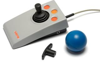
**제 품 개 요** 장애로 인해 상지의 움직임이 불편 해 일반 마우스를 사용하기 어려운 분들에게 적합한 조이스틱 마우스입니다. (마우스 모드, WASD 모드, 방향키 모드 선택 사용)
