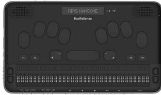
**제품개요** 소리(TTS)와 촉각(점자 셀)을 이용하여 워드프로세서, 독서기, 인터넷, 녹음, 이메일 등 다양한 응용프로그램 활용 및 안드로이드 운영체제를 통해 수많은 어플리케이션 사용이 가능하며 심플한 디자인과 휴대성으로 최고의 접근성을 제공하는 점자정보단말기
