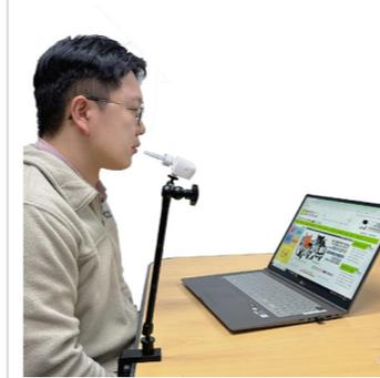
**제품개요** 지체/뇌병변장애로 인해 상하지를 사용하기 어려운 장애인 분들 중 머리의 움직임을 통해 (조이스틱 타입의 마우스로 스틱의 움직임을 통해 마우스 포인터가 움직이고, 입으로 가해주는 압력을 통해 기능 실행) / 일반 마우스 및 손가락의 기능처럼 PC, 핸드폰 등의 마우스 포인터를 컨트롤 할 수 있는 특수 마우스입니다.
