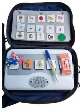
**제품개요** RFID 기술을 사용하여 RF 태그에 저장된 해당 어휘를 출력하는 언어훈련, 학습 및 의사소통보조장치로 청각, 발달, 뇌병변, 자폐, 시각, 기타 발생 및 의사소통의 어려움이 있는 모든 사람이 사용할 수 있는 보조기기입니다
