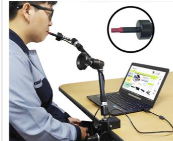
**제품개요** 지체/뇌병변장애로 인해 상하지를 사용하기 어려운 장애인 중에서도 머리의 움직임이 제한 적인 분들을 위한 특수 마우스입니다. 기존의 호흡을 통한 클릭이 아닌 틱의 아래면 과 윗면을 입술로 터치하는 동작으로 클릭을 합니다. 작은 움직임으로 마우스 포인트의 이동이 가능 합니다.
