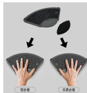
**제품개요** 지체/뇌병변장애로 인해 한손만 사용하는 장애인을 위한 한손사용자용 키보드입니다. / 블루투스 연결 및 유선 연결과 휴대용 가방을 통해 휴대 및 이동이 간편하고 PC, IOS, 안드로이드 등 다양한 운영체제에서 사용이 가능합니다. 키보드 기능 외에 마우스 기능도 탑재 되어 있습니다.
