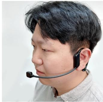
**제품개요** 지체/뇌병변장애로 인해 상하지를 사용하기 어려운 장애인 분들 중 머리의 움직임을 통해(기울기 센서 모듈을 통한 머리움직임 측정) 일반 마우스 및 손가락의 기능처럼 PC, 핸드폰 등의 마우스 포인터를 컨트롤 할 수 있는 특수 마우스입니다.
